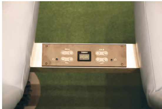
HCS-4325U/50, HCS-4325/50 Double sélecteur de 64 canaux installé à la salle de presse (ONU)
